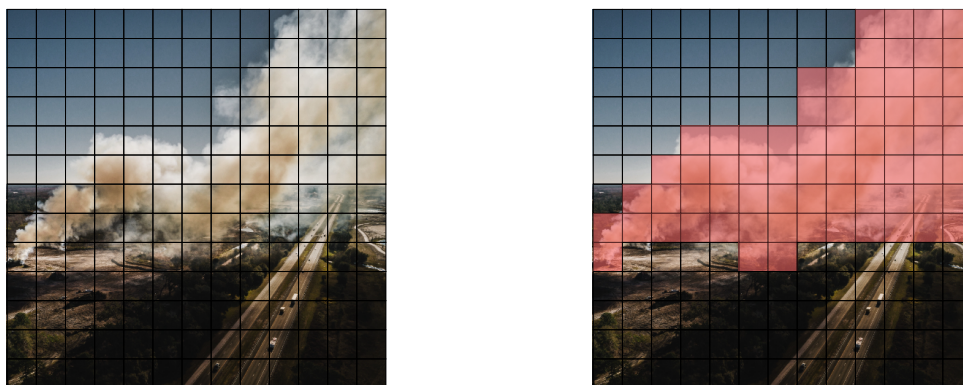
Figura 3.26: Grade de células S \times S com S = 13 . Cada uma das células é colorida conforme a classe que tem a maior probabilidade prevista nessa célula, gerando um mapa de probabilidades de classe (à direita). Nesse exemplo, células com alta probabilidade de conter fumaça são coloridas de vermelho.
