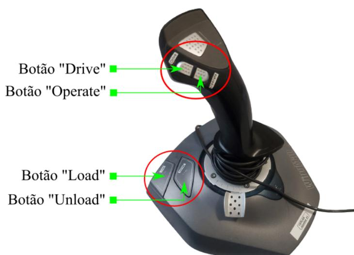
Figura 29 – Ilustração dos botões do *joystick* não háptico utilizados no arcabouço computacional de teleoperação.
