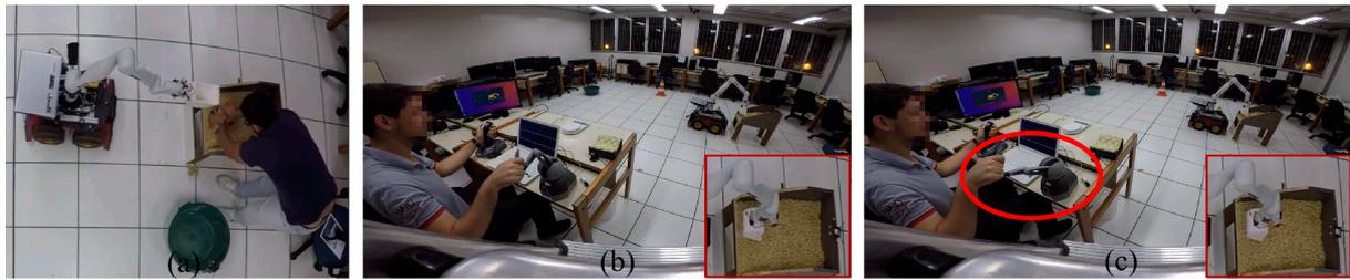
Figura 38 – Ensaio em laboratório sobre a identificação de corpos volumosos e rígidos durante a execução de uma tarefa de escavação: (a) momento em que o objeto é enterrado; (b) tentativa de escavar material na caixa onde o objeto foi enterrado; e (c) resposta da realimentação de força no dispositivo háptico.
