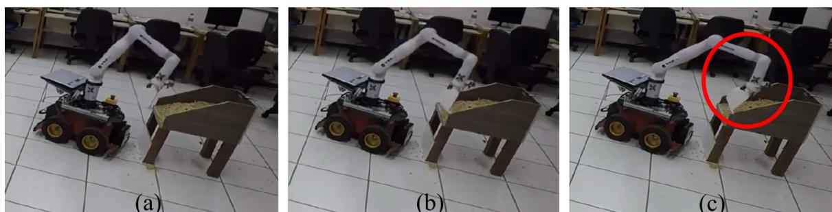
Figura 37 – Demonstração de uma possível consequência da ausência de realimentação de força na teleoperação de uma escavadeira: (a) início do ensaio utilizando a configuração  $C1$ ; (b) momento em que a caçamba toca a caixa de escavação; e (c) caçamba da escavadeira robótica sendo arrancada devido aos esforços excessivos contra a caixa de escavação.
