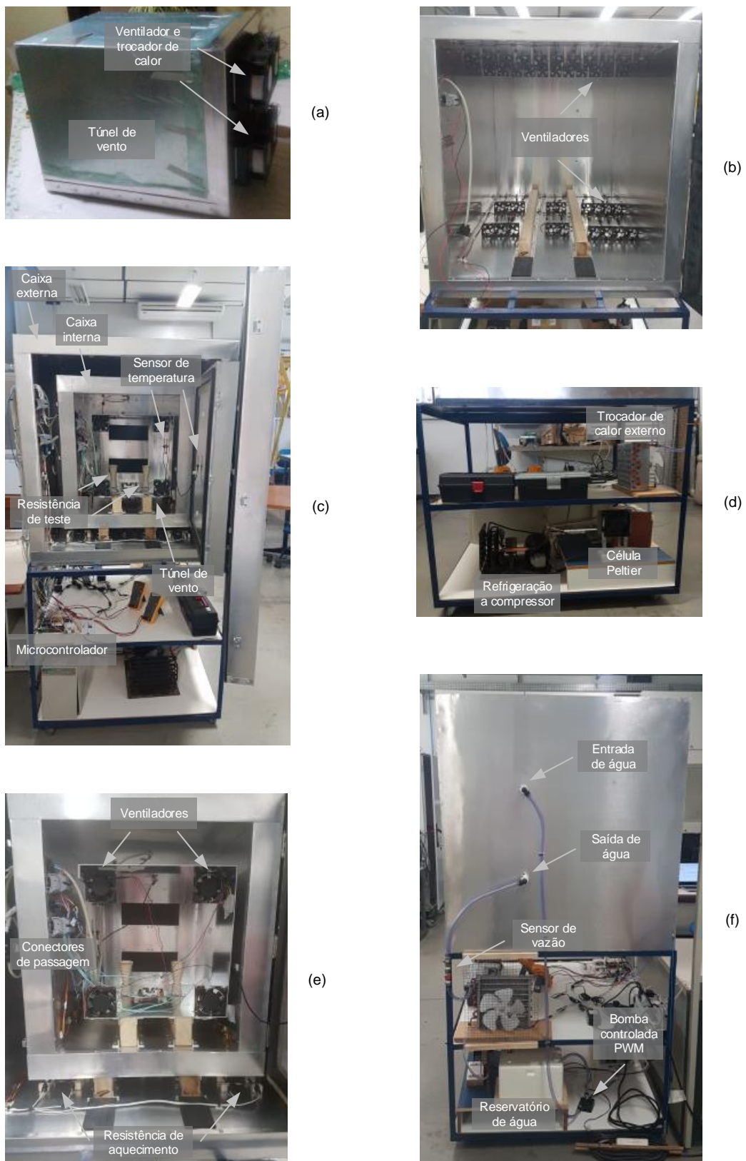
Figura 4.5 – Montagem do calorímetro do tipo caixa duplo (protótipo I).
