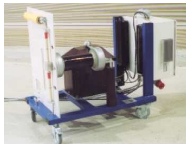
Figura 5.14- Figura representativa retificador utilizado na pesquisa. Retirado do catálogo Haefely (2014).
