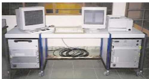
Figura 5.16- Figura representativa analisador de impulso utilizado na pesquisa. Retirado do catálogo Haefely (2014).
