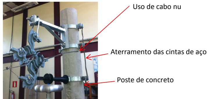
Figura 5.19- Representação do uso do cabo nu para testes, estrutura CE1.
