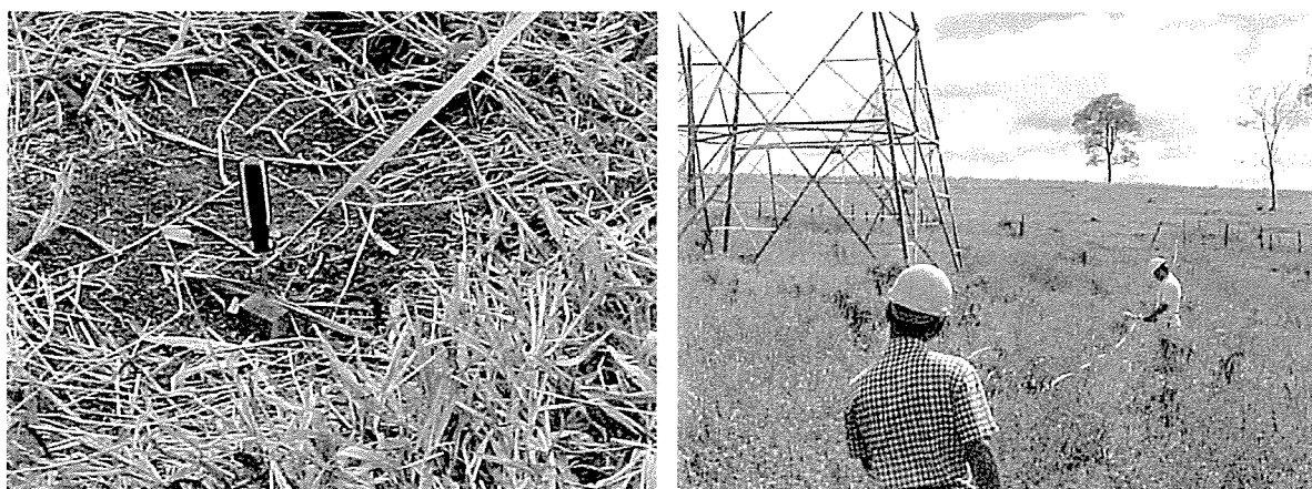
Figura 3.4 – Detalhe dos piquetes utilizados e o eixo perpendicular a LT marcado pelas trenas métricas.
